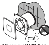
Швидкий монтаж за допомогою затискачів у будь-якому отворі
