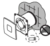
Szybki montaż za pomocą zacisków w dowolnym otworze
